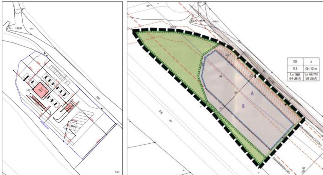
Abbildung 1. Auszüge des Lageplans zum Bauantrag (Stand: 04.05.2023), links, sowie des Bebauungsplanes „Gewerbegebiet Odelzhausen – östlich der BAB A8“ (Stand: 13.12.2021).
